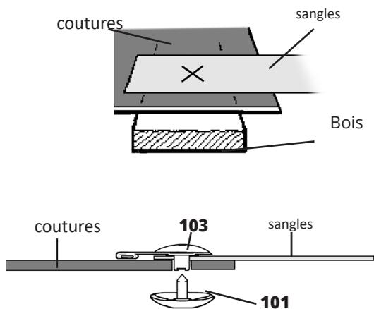
Placez la sangle bleue sur la housse. Faites une coupe transversale à travers le sanglage et la housse. Assurez-vous que le trou dans le sanglage est à un minimum 1" du bout de la sangle et que le trou dans la housse est au moins à 2" du bord de la housse. Si possible, pliez le bord de la housse afin de mettre l'œillet à travers deux couches de housse. Ceci assurera que l'œillet est sécuritairement placé sur la sangle et la housse ainsi qu'aide à prévenir des déchirements.
