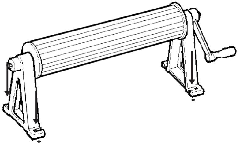
En utilisant les deux trous dans le cadre comme guides, faites deux marques sur le patio pour chaque cadre. À l'aide d'une mèche en béton de 1/2", faites un trou vertical de 1 1/2" là où se trouve chaque marque.
