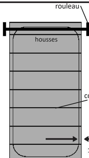
Ouvrez le couvert au-dessus de la piscine. Assurez-vous que le bout de la housse (où il s'attache au rouleau) est carré au rouleau. Lorsque vous coupez la housse, laissez une bordure de 1" autour du bord de la piscine pour compenser pour un rapetissement. Si la housse à des coutures, ces derniers devraient être parallèles au rouleau. (Ceci ne sera pas possible avec certaines housses)
