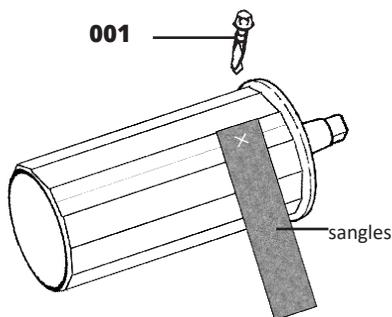
À l'aide des vis Tek, attachez la sangle au rouleau. Assurez-vous d'avoir placé la vis à environ 1" dans la sangle pour éviter les déchirements.
