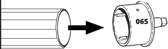
À l'aide de deux vis TEK, attachez le moyeu au tube à l'aide d'une perceuse.
