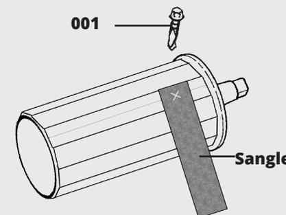
À l'aide des vis Tek, attachez la sangle au rouleau. Assurez-vous d'avoir placé la vis à environ 1" dans la sangle pour éviter les déchirements.
