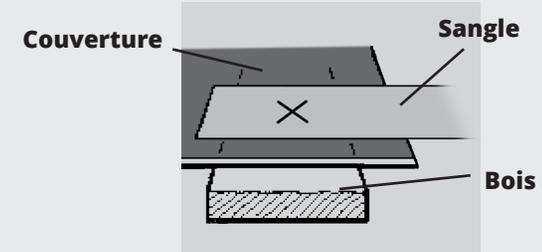
Placez la sangle bleue sur la housse. Faites une coupe transversale à travers le sanglage et la housse. Assurez-vous que le trou dans le sanglage est à un minimum 1" du bout de la sangle et que le trou dans la housse est au moins à 2" du bord de la housse. Si possible, pliez le bord de la housse afin de mettre l'œillet à travers deux couches de housse. Ceci assurera que l'œillet est placé en toute sécurité sur la sangle et la housse ainsi qu'aide à prévenir des déchirements.
