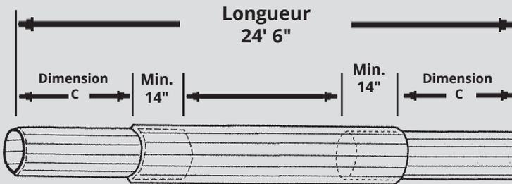
Insérez les tubes avec le plus petit diamètre à l'intérieur du tube d'un diamètre supérieur jusqu'à ce que vous atteignez la marque de la dimension C (voir diagramme). La somme de la longueur des tubes devrait être approximativement égal à la valeur correspondante dans la colonne B. Voir l'exemple au verso.
