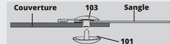
Insérez l'œillet femelle à travers la coupure dans le sanglage et la housse. Assurez-vous que le matériel soit fermement inséré dans le châssis. Insérez l'œillet mâle dans l'œillet femelle. Une fois en place, martelé jusqu'à ce que ce soit fermement attaché. (Notez Bien : Force excessive brisera l'œillet).
