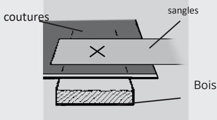
Placez la sangle bleue sur la housse. Faites une coupe transversale à travers le sanglage et la housse. Assurez-vous que le trou dans le sanglage est à un minimum 1" du bout de la sangle et que le trou dans la housse est au moins à 2" du bord de la housse. Si possible, pliez le bord de la housse afin de mettre l'œillet à travers deux couches de housse. Ceci assurera que l'œillet est sécuritairement placé sur la sangle et la housse ainsi qu'aide à prévenir des déchirements.
