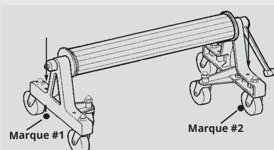
En utilisant l'un des deux trous d'un côté du cadre comme guide, faites une marque #1 sur le patio. À l'aide d'une mèche en béton 1/2", faites un trou d'une profondeur de 1 1/2". Veuillez procéder aux étapes 5 et 6 avant de poursuivre de l'autre côté de l'unité. De l'autre côté de l'unité de bobines, faites une marque #2 en utilisant l'un des deux trous dans le cadre de ce côté de l'unité comme guide. À l'aide d'une mèche en béton 1/2", faites un trou d'une profondeur de 1 1/2" où la marque #2.
