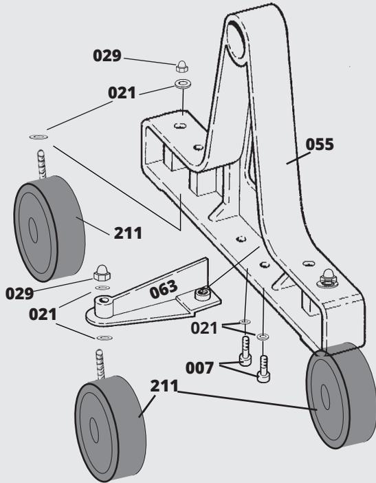
Boulonnez les roulettes au cadres et au cadre de la 3e patte comme dans le diagramme. Ensuite, boulonnez la 3e patte au cadres. Assemblez un des unités de fin au tube avec la grande poignée comme dans le diagramme. Assemblez l'autre bout de l'unité au tube en utilisant le bouton. Pour rendre l'opération du système plus souple, appliquez de la graisse imperméable entre le moyeu et le manchon en plastique. Ceci devrait être fait une fois par an.
