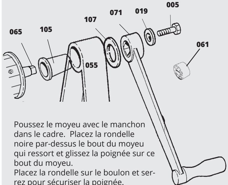
Poussez le moyeu avec le manchon dans le cadre. Placez la rondelle noire par-dessus le bout du moyeu qui ressort et glissez la poignée sur ce bout du moyeu. Placez la rondelle sur le boulon et serrez pour sécuriser la poignée.
