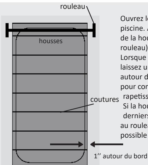
Ouvrez le couvert au-dessus de la piscine. Assurez-vous que le bout de la housse (où il s'attache au rouleau) est carré au rouleau. Lorsque vous coupez la housse, laissez une bordure de 1" autour du bord de la piscine pour compenser pour un rapetissement. Si la housse à des coutures, ces derniers devraient être parallèle au rouleau. (Ceci ne sera pas possible avec certaines housses)
