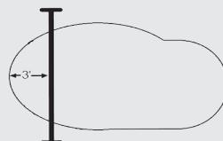
Pour piscines de formes irrégulières, le côté extérieur du tube devrait être à un minimum de 3' à l'intérieur du bord de la piscine. Pour de meilleurs résultats, placez la bobine au point le plus large de la piscine.
