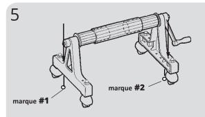
En utilisant l'un des deux trous d'un côté du cadre comme guide, faites une marque #1 sur le patio. À l'aide d'une mèche en béton ½", faites un trou d'une profondeur de 1 ½". Veuillez procéder aux étapes 6 et 7 avant de poursuivre de l'autre côté de l'unité. De l'autre côté de l'unité de bobines, faites une marque #2 en utilisant l'un des deux trous dans le cadre de ce côté de l'unité comme guide. À l'aide d'une mèche en béton ½", faites un trou d'une profondeur de 1 ½" où la marque #2.
