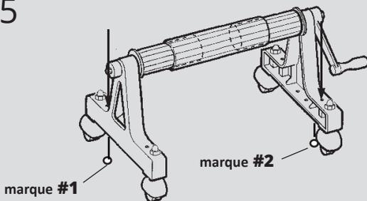
En utilisant l'un des deux trous d'un côté du cadre comme guide, faites une marque #1 sur le patio. À l'aide d'une mèche en béton 1/2", faites un trou d'une profondeur de 1 1/2". Veillez procéder aux étapes 6 et 7 avant de poursuivre de l'autre côté de l'unité. De l'autre côté de l'unité de bobines, faites une marque #2 en utilisant l'un des deux trous dans le cadre de ce côté de l'unité comme guide. À l'aide d'une mèche en béton 1/2", faites un trou d'une profondeur de 1 1/2" où la marque #2.
