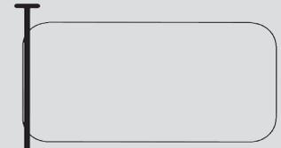
Pour piscines de formes irrégulières, le côté extérieur du tube devrait être à un minimum de 3' à l'intérieur du bord de la piscine. Pour de meilleurs résultats, placez la bobine au point le plus large de la piscine.
