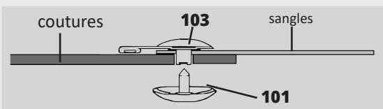
Insérez l'œillet femelle à travers la coupure dans le sanglage et la housse. Assurez-vous que le matériel soit fermement inséré dans le châssis. Insérez l'œillet mâle dans l'œillet femelle. Une fois en place, martelé jusqu'à ce que ce soit fermement attaché. (Notez Bien : Force excessive brisera l'œillet).
