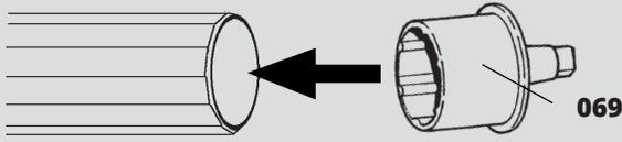
En utilisant 4 vis TEK (2 pour chaque moyeu), attachez les moyeux de 4" au tubes.
