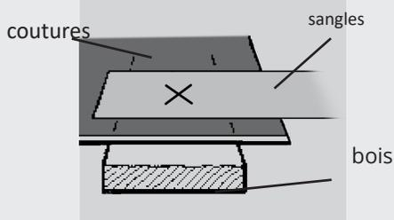
Placez la sangle bleue sur la housse. Faites une coupe transversale à travers le sanglage et la housse. Assurez-vous que le trou dans le sanglage est à un minimum 1" du bout de la sangle et que le trou dans la housse est au moins à 2" du bord de la housse. Si possible, pliez le bord de la housse afin de mettre l'œillet à travers deux couches de housse.
