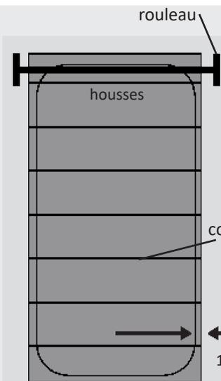
Ouvrez le couvert au-dessus de la piscine. Assurez-vous que le bout de la housse (où il s'attache au rouleau) est carré au rouleau. Lorsque vous coupez la housse, laissez une bordure de 1" autour du bord de la piscine pour compenser pour un rapetissement. Si la housse à des coutures, ces derniers devraient être parallèle au rouleau. (Ceci ne sera pas possible avec certaines housses)
