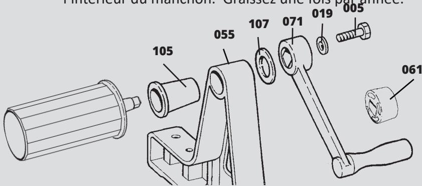
Poussez le moyeu avec le manchon dans le cadre. Placez la rondelle noire par-dessus le bout du moyeu qui ressort et glissez la poignée sur ce bout du moyeu. Placez la rondelle sur l'écrou et serrez pour positionner la poignée.
