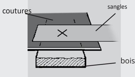
Placez la sangle bleue sur la housse. Faites une coupe transversale à travers le sanglage et la housse. Assurez-vous que le trou dans le sanglage est à un minimum 1" du bout de la sangle et que le trou dans la housse est au moins à 2" du bord de la housse. Si possible, pliez le bord de la housse afin de mettre l'œillet à travers deux couches de housse.
