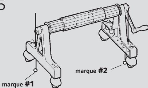
En utilisant l'un des deux trous d'un côté du cadre comme guide, faites une marque #1 sur le patio. À l'aide d'une mèche en béton 1/2", faites un trou d'une profondeur de 1 1/2". Veillez procéder aux étapes 6 et 7 avant de poursuivre de l'autre côté de l'unité. De l'autre côté de l'unité de bobines, faites une marque #2 en utilisant l'un des deux trous dans le cadre de ce côté de l'unité comme guide. À l'aide d'une mèche en béton 1/2", faites un trou d'une profondeur de 1 1/2" où la marque #2.
