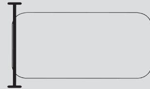
Pour piscines de formes irrégulières, le côté extérieur du tube devrait être à un minimum de 3' à l'intérieur du bord de la piscine. Pour de meilleurs résultats, placez la bobine au point le plus large de la piscine.
