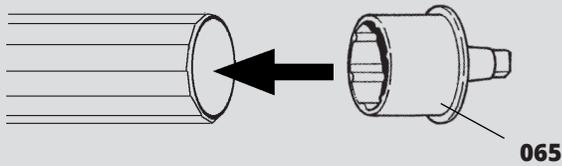
En utilisant 4 vis TEK (2 pour chaque moyeu), attachez les moyeux de 4" au tubes.
