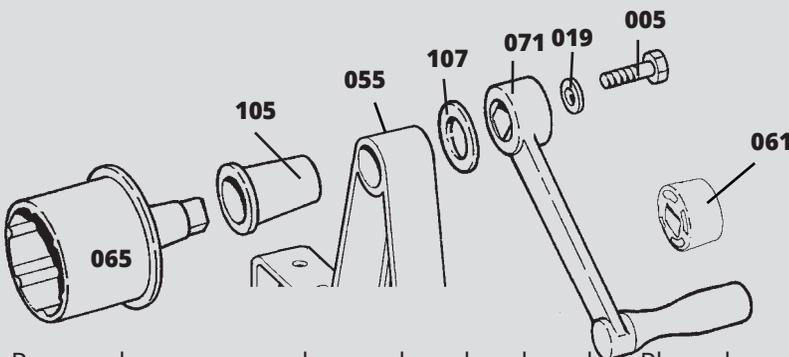
Poussez le moyeu avec le manchon dans le cadre. Placez la rondelle noire par dessus le bout du moyeu qui ressort et glissez la poignée sur ce bout du moyeu.
