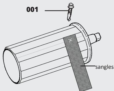
À l'aide des vis Tek, attachez la sangle au rouleau. Assurez-vous d'avoir placé la vis à environ 1" dans la sangle pour éviter les déchirements.
